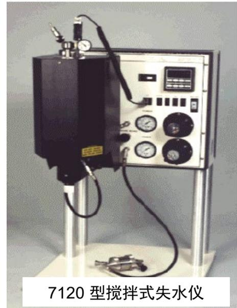
API 要求在确定水泥浆失水仪特性时,按照 API 规范,被测水泥浆在测量前需在设定温度下需搅拌 20 分钟进行水泥浆预制工作,如果用常规静态失水仪测定仪进行此测试时,需先将被测水泥浆在常压稠化仪中搅拌预制 20 分钟,然后操作人员将加热后的水泥浆样倒入静态失水仪的失水筒中,这种方法既不方便也不安全,温度高时有被烫伤的危险。而且由于常压稠化仪没有办法在温度高于 93°C 时预制水泥浆,所以静态失水仪并不适合做高温失水试验。
