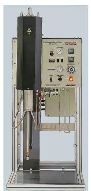
实验准备时,使用漏液接收器压力调节器,施加 100psi(估计)来移动内部活塞,直到它与缝板紧密接触,将缝板和活塞之间的容积降为零。 倒入样品后,打开马达开关,叶片一直搅拌水泥或者泥浆样品,仪器面板上温度控制器自动控制样品筒中样品的加热到设定温度,压力控制器按照设定压力,自动控制压力调节阀,对缝板上方的样品筒施加设定的压力,一旦容器温度和压力稳定,使用滤液压力调节器来降低滤液接收器内活塞下方的压力,从而在缝板上下内形成所需的压差。
