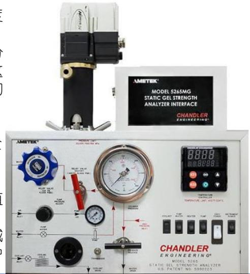
机械式静胶凝强度测量模块
